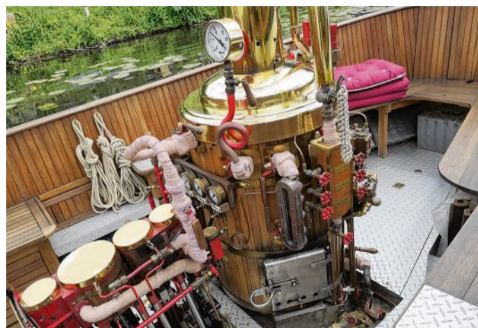
Viele Ventile und Manometer sind die Klaviatur des Dampfboot-Kapitäns. Er ist Maschinist, Steuermann und Heizer zugleich.
